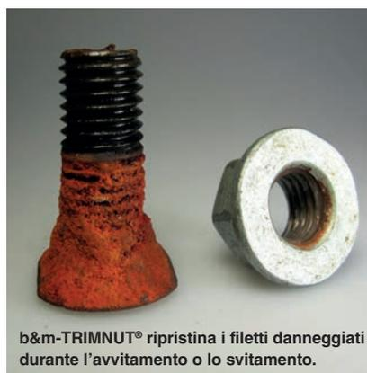
un grande problema in caso di riparazione. L'accessibilità dei filetti interessati è spesso limitata e pertanto si rende necessario lo smontaggio dell'intero modulo in officina. Inoltre, i collegamenti a vite con filetti danneggiati o arrugginiti in caso di sostituzione delle parti usurate sono spesso un problema "irrisolvibile", perché non si riescono a sbloccare i dadi.
